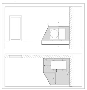
A 9kW - 2167 / 15kW - 2287 / 22kW - 2250mm B 9kW - 2667 / 15kW - 2787 / 22kW - 2750mm
