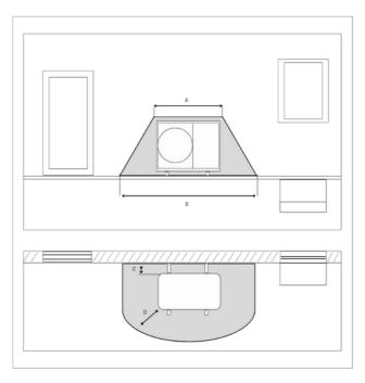
A 9kW - 2167 / 15kW - 2287 / 22kW - 2250mm C 300\* B 9kW - 3167 / 15kW - 3287 / 22kW - 3250mm D 1000\*
